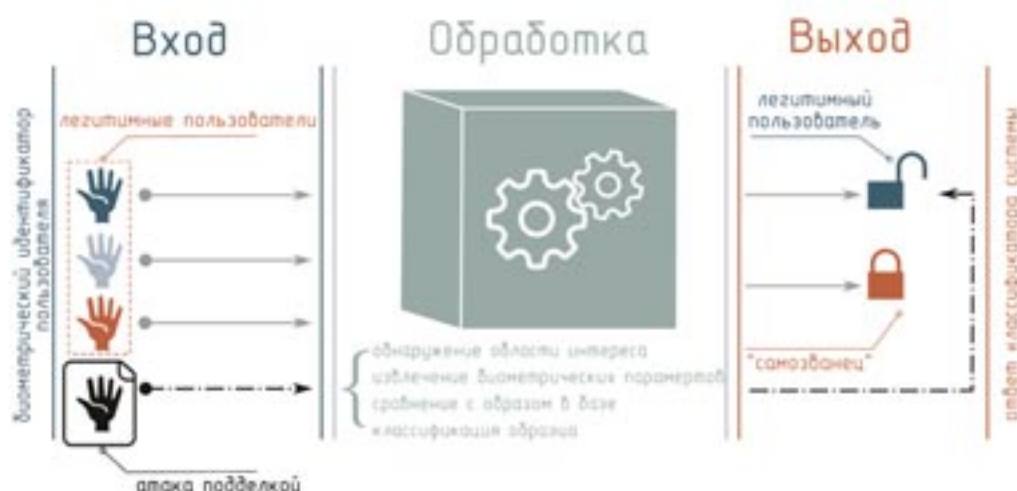
Рисунок 3. Упрощённая схема работы биометрической системы.
