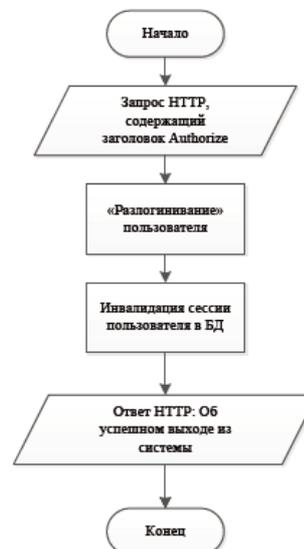
Рис. 4. Блок-схема алгоритма выхода пользователя по токenu.
