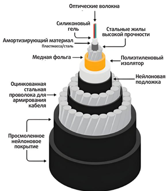
Рис. 1. Сечение подводного оптоволоконного кабеля.
